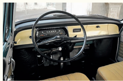
ŠKODA 1000 MB получила современный дизайн торпеды с приборами, объединенными в общем корпусе.
